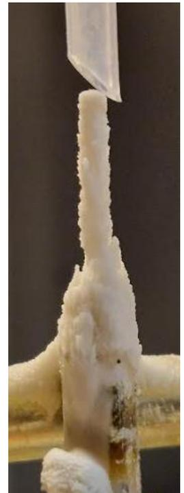
Figure 23 : Réalisation d'une stalagmite de billes de verre sphériques
